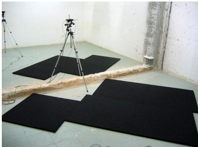
Fig. 1: Vista del campione testato nella camera riverberante.
